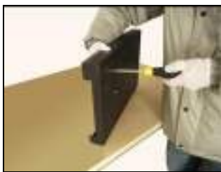
4.закрутите винты HDD
