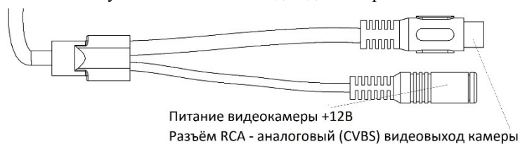
Рисунок 2 – Назначение разъемов видеокамеры EVM1-IPx (п/п 1-4 см. табл. исполнений)
