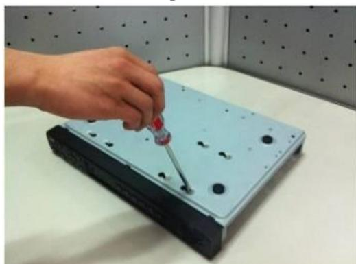
Подключите SATA кабель и кабель питания. Закройте корпус верхней крышкой и прикрутите винты крепления.
