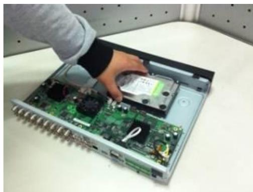
Закрепите жесткий диск на нижней панели при помощи винтов через соответствующие отверстия.
