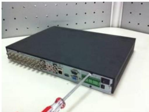
Снимите верхнюю крышку и поместите жесткий диск внутрь корпуса
