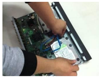
Падключыце SATA кабель і кабель харчавання на ніжняй і задняй частцы корпуса і зачыніце корпус верхняй вечкам.
