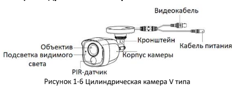
Рисунок 1-6 Цилиндрическая камера V типа
