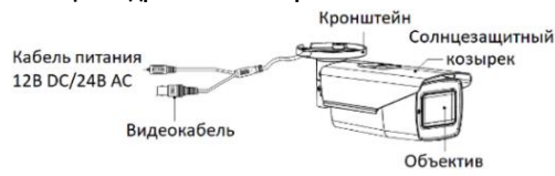
Рисунок 1-9 Цилиндрическая камера VII типа
