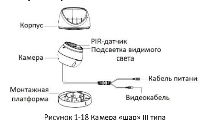
Рисунок 1-18 Камера «шар» III типа
