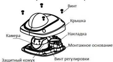
Рисунок 1-23 Настройка угла наблюдения камеры
