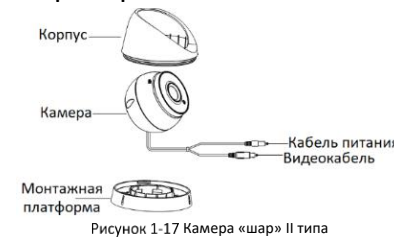
Рисунок 1-17 Камера «шар» II типа
