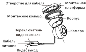
Рисунок 1-20 Камера «шар» V типа
