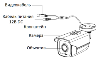
Рисунок 1-4 Цилиндрическая камера III типа
