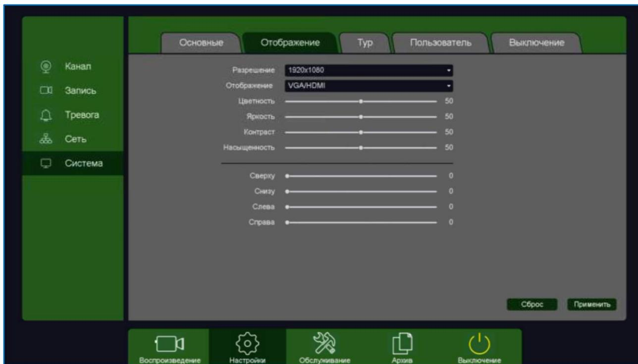
**Разрешение** – разрешение изображение на подключенном мониторе.
