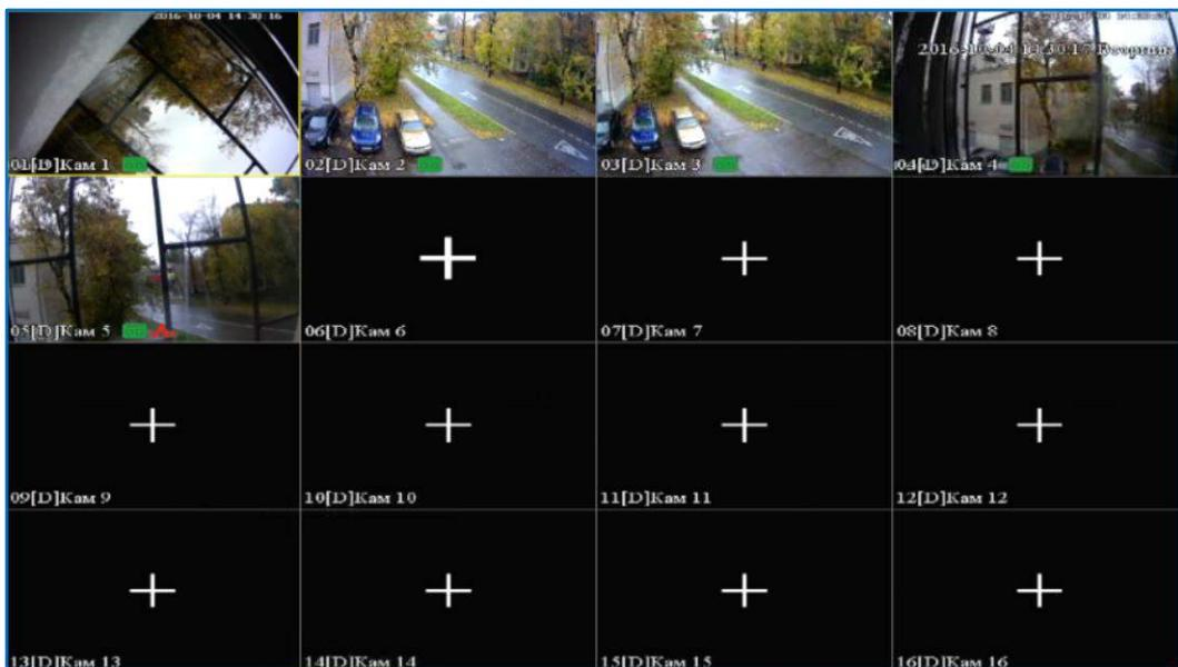
Для настройки расположения отображения камеры просто перетащите окно отображения камеры в нужную позицию на экране монитора.
