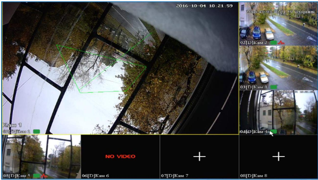
На верхней камере при установленном параметре отображаются настройки детектора пересечения линии и настройки детектора вторжения.
