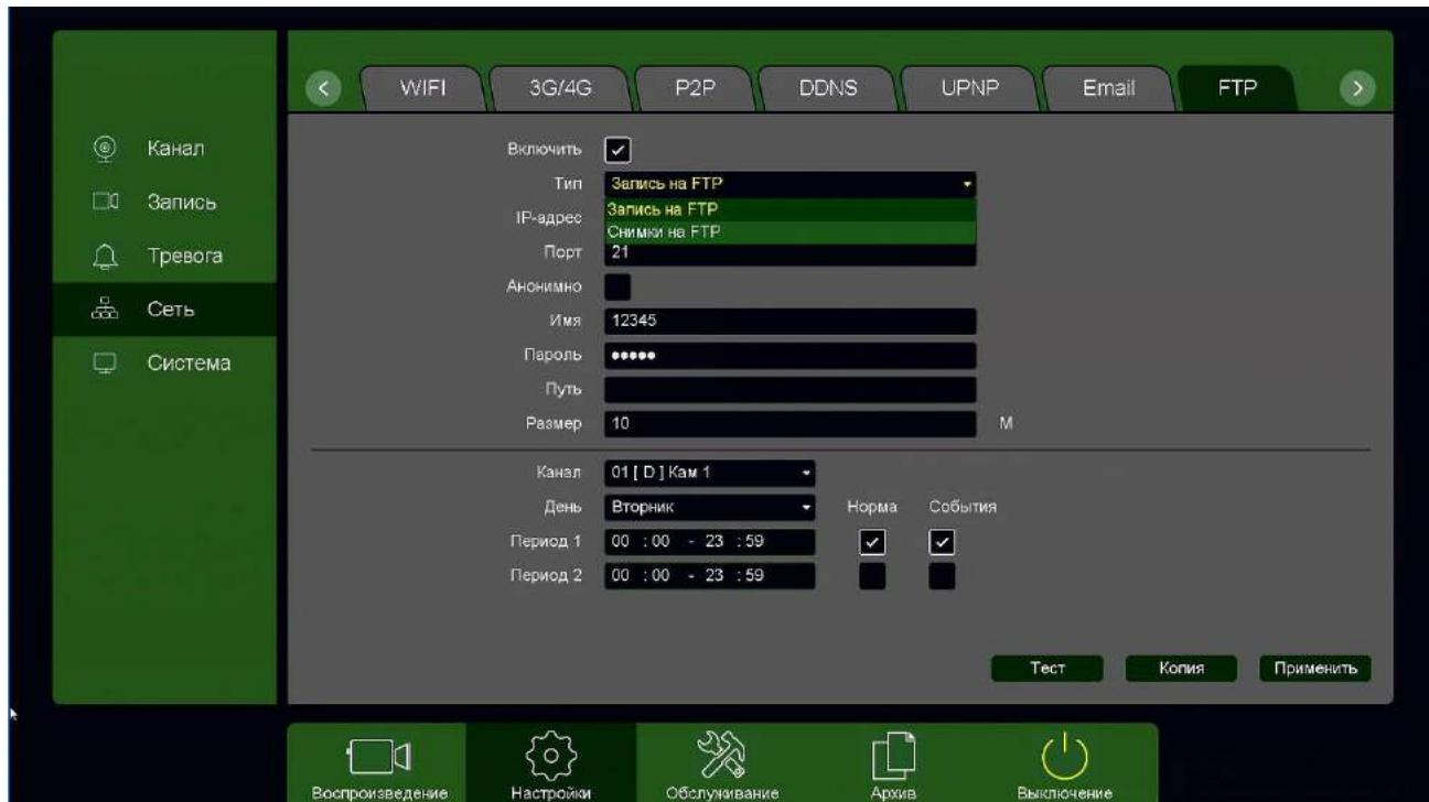
**Тип** – тип отправляемых на FTP сервер файлов. **Запись на FTP** – файлы видео в формате dav, **Снимки на FTP** – кадры в формате jpg.
