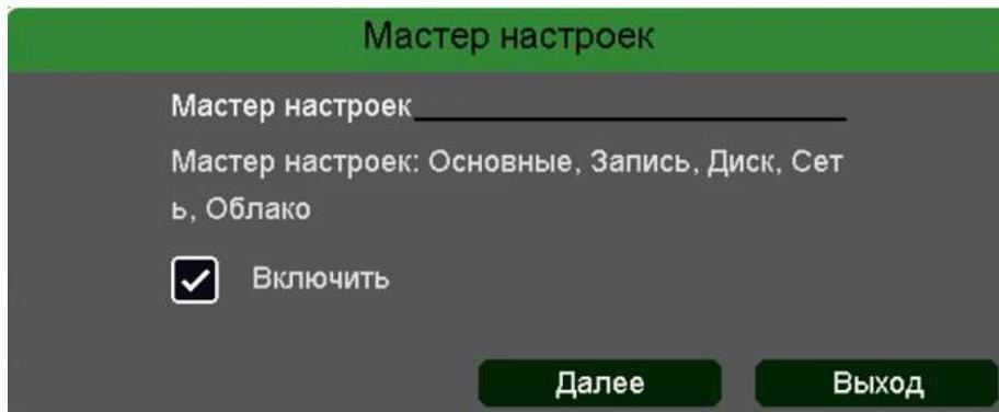
Мастер настроек автоматически запускается при включении регистратора, для отмены запуска мастера настроек снимите галочку **Включить**.
