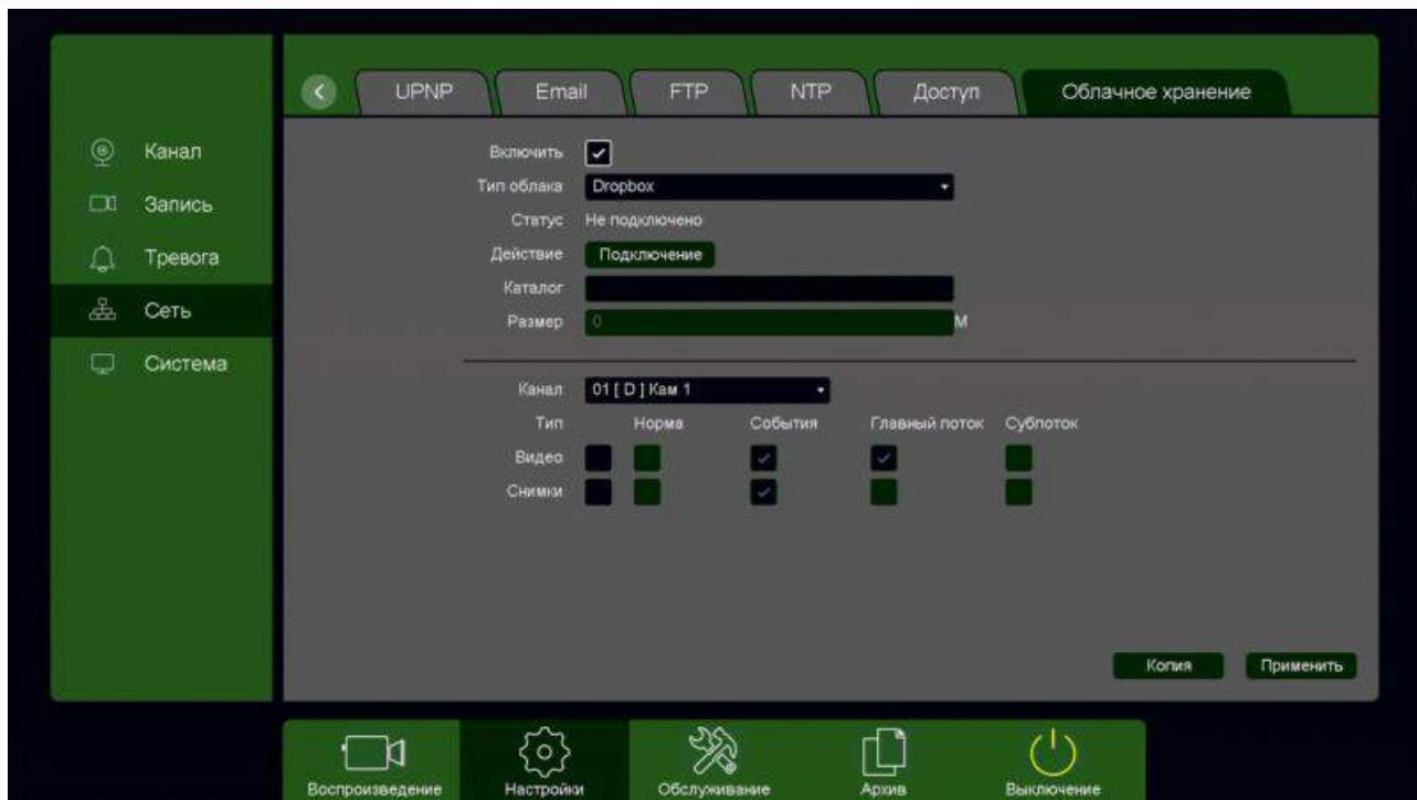
Для синхронизации с Dropbox поставьте галочку **Включить**, выберите **Тип облака – Dropbox** и нажмите кнопку **Подключение**.
