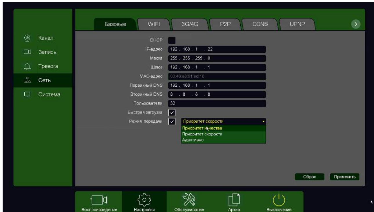
Можно задать получение адреса регистратором от DHCP (при этом необходимо, чтобы сервер DHCP был в сети) сервера при установке параметра **DHCP**, либо вручную.
