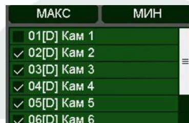
При выборе определенного количества камер автоматически выбирается шаблон отображения (1, 4, 9, 16 камер и т.д.)
