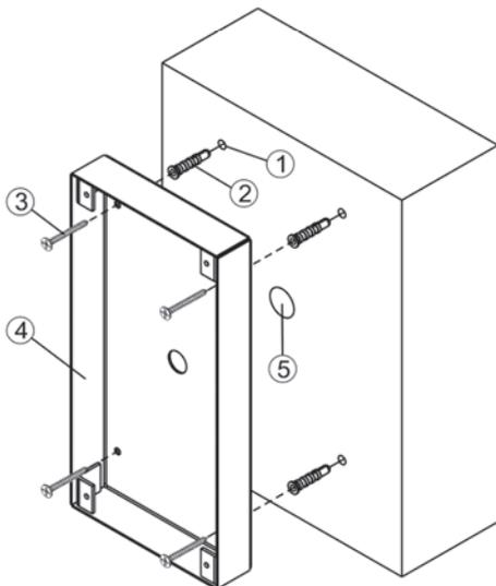
**Установка монтажного комплекта МК-423 на стену (накладной вариант)**
