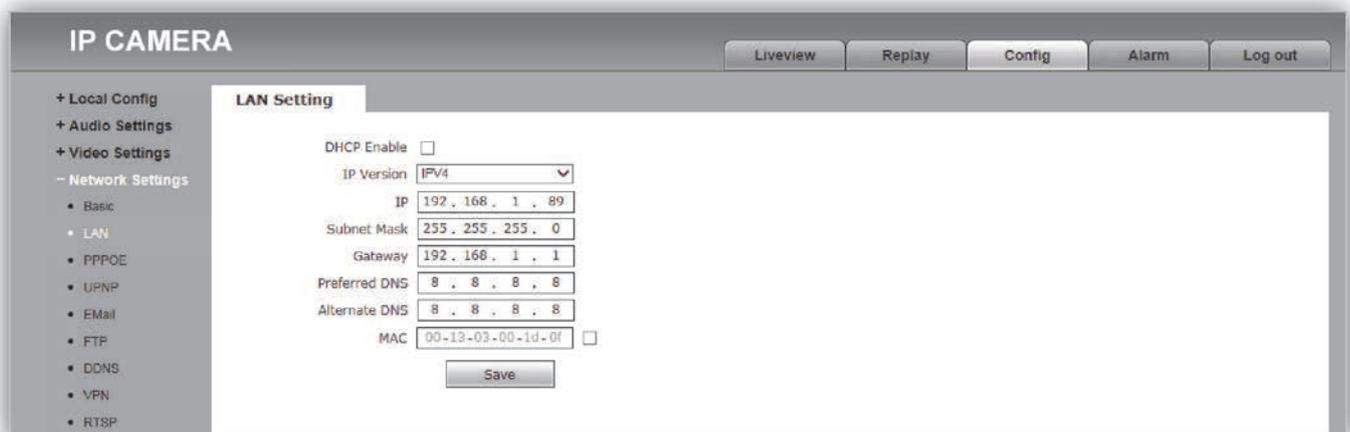
Рисунок 14.11 - Окно Установки подключения к локальной сети (LAN)
