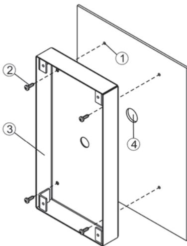
**Установка монтажного комплекта МК-423 на металлическую дверь (накладной вариант)**
