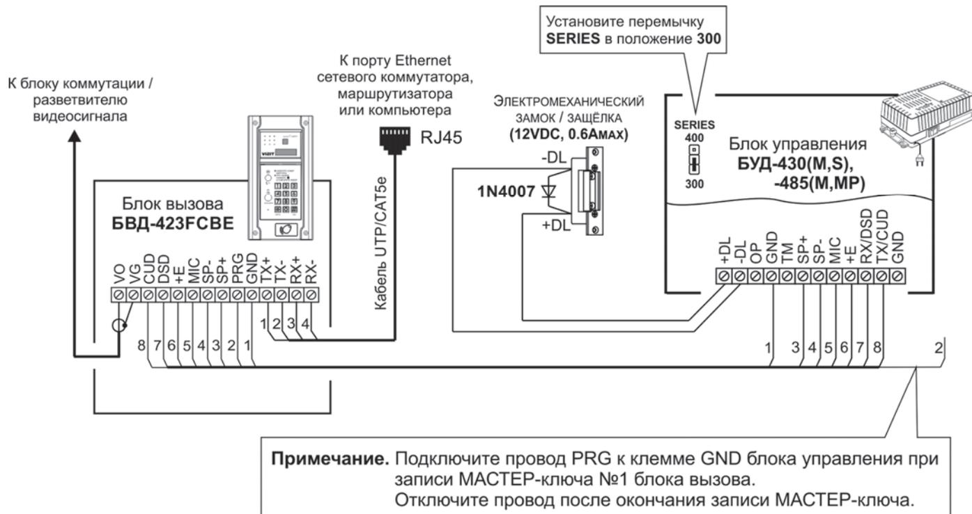
Если электромеханический замок / защёлка не содержат встроенный защитный диод, то между клеммами замка / защёлки следует установить диод, как показано на схеме
