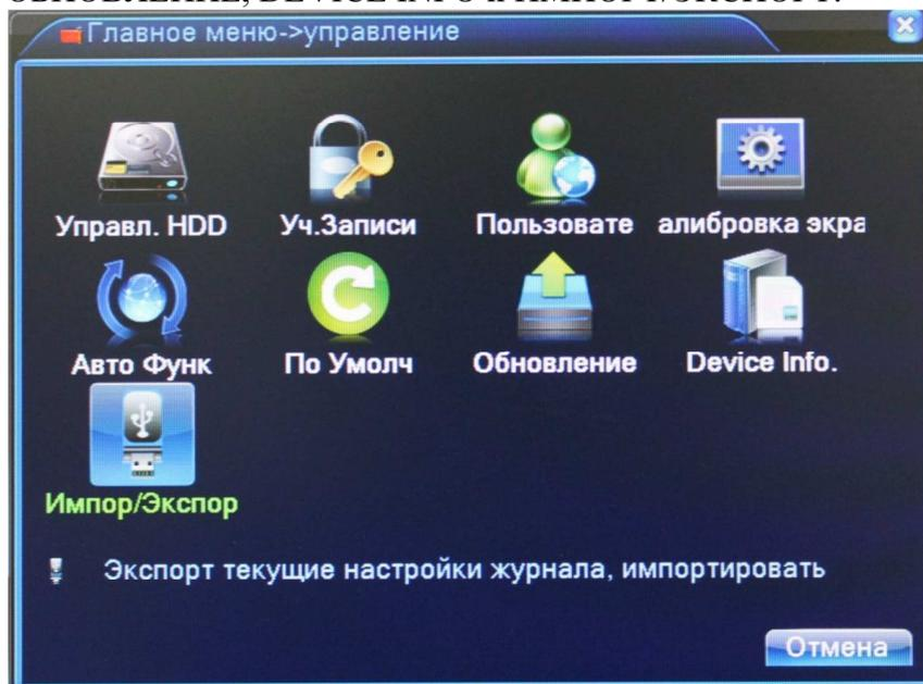
**УПРАВЛЕНИЕ HDD:** Меню управления подключенными HDD (установка на чтение/запись, только чтение, форматирование и т.д.)
