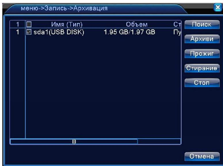
Примечание: для резервного копирования и хранения файлов необходимо установить устройство для накопления и хранения данных. При отмене операции резервного копирования, остается сохраненной имеющаяся часть файла.
