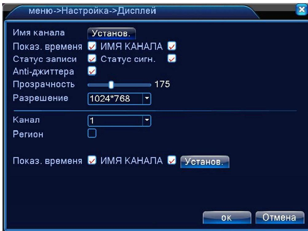
**ИМЯ КАНАЛА:** Здесь вы можете поменять имя любого канала со стандартного (CAM01) на любое другое. Опция с галочкой означает, что вы можете поставить или убрать отображение на дисплее имени канала
