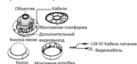
Рисунок 1-13 Купольная камера III типа
