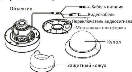
Рисунок 1-12 Купольная камера II типа
