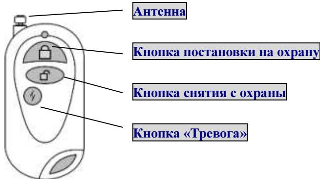
Нажмите кнопку “” на брелоке, контрольная панель перейдет в режим охраны с задержкой в 30секунд. Находясь в режиме охраны, при сработке любого датчика, контрольная панель будет передавать сигналы тревоги, а сирена будет звенеть 3 минуты.
