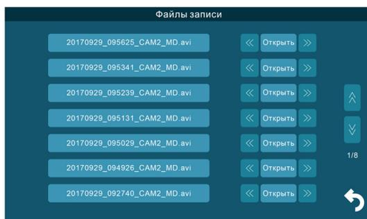
В этом разделе пользователь может выбрать и воспроизвести файлы видеозаписей и просмотреть сохраненные фотографии, а также удалить ненужные. Для выбора файла следует установить курсор на него, используя поворот колесика, а затем нажать на кнопку меню два раза. Для удаления файла, нужно нажать кнопку меню один раз, а затем повернуть колесико вверх, чтобы значение параметра
