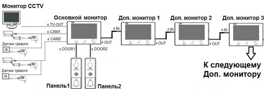
Вызывные панели подключаются только к основному монитору.
