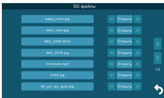
В этом разделе можно просмотреть все файлы, которые записаны на карту памяти microSD, с помощью компьютера или прочего стороннего оборудования. Файлы, записанные самим монитором, здесь не отображаются. Монитор поддерживает воспроизведение видеофайлов в форматах avi и mp4, аудиофайлов в формате mp3, графических файлов в форматах jpg, png и bmp. Навигация, запуск и удаление файлов в этом разделе аналогичны этим же операциям раздела «Файлы записи», который описан ранее в этой инструкции.
