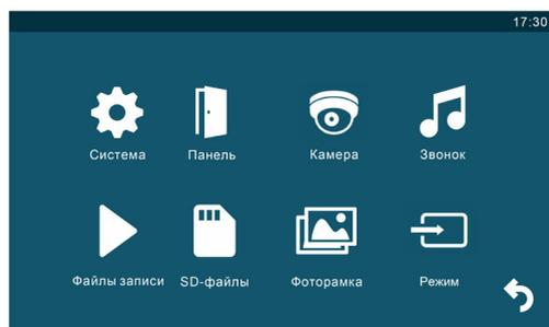
Для навигации по разделам меню используется прокрутка кнопки-колесика, а для входа в нужный раздел следует нажать на неё. Находясь в выбранном разделе, выбор нужного параметра осуществляется нажатием на кнопку-колесико, а регулировка значений - прокруткой.
