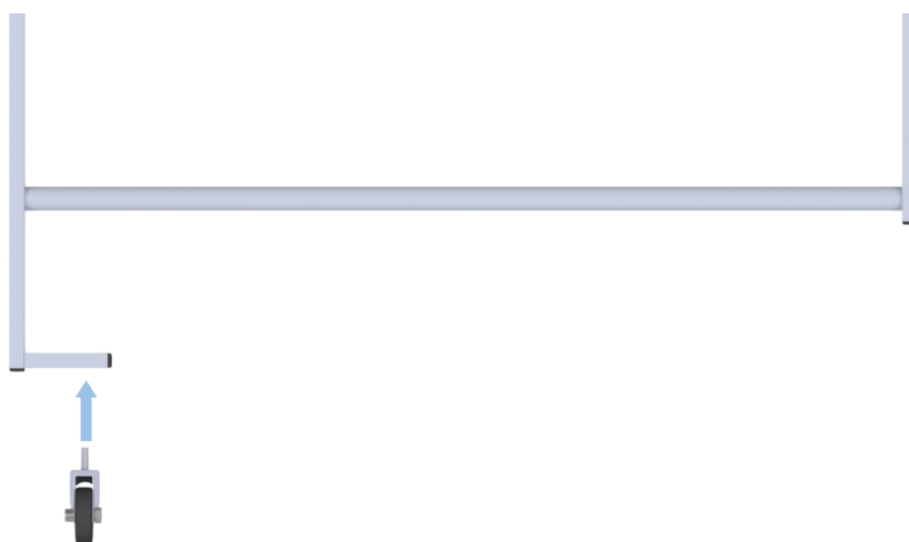
Рисунок 7.2.2 Установка опорного колеса
