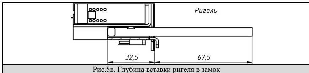
Рис.5в. Глубина вставки ригеля в замок
