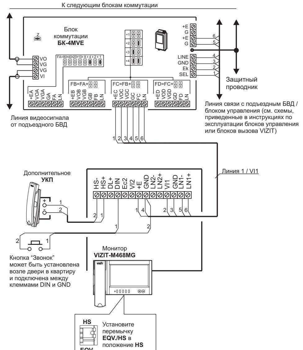
Схема соединений монитора с блоком коммутации подъездного / многоабонентского видеодомофона, дополнительным УКП и кнопкой "Звонок".
