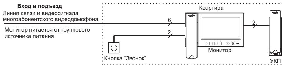
**Монитор в составе многоабонентского видеодомофона. Телекамера и кнопка “Звонок” на входе в квартиру и УКП.**
