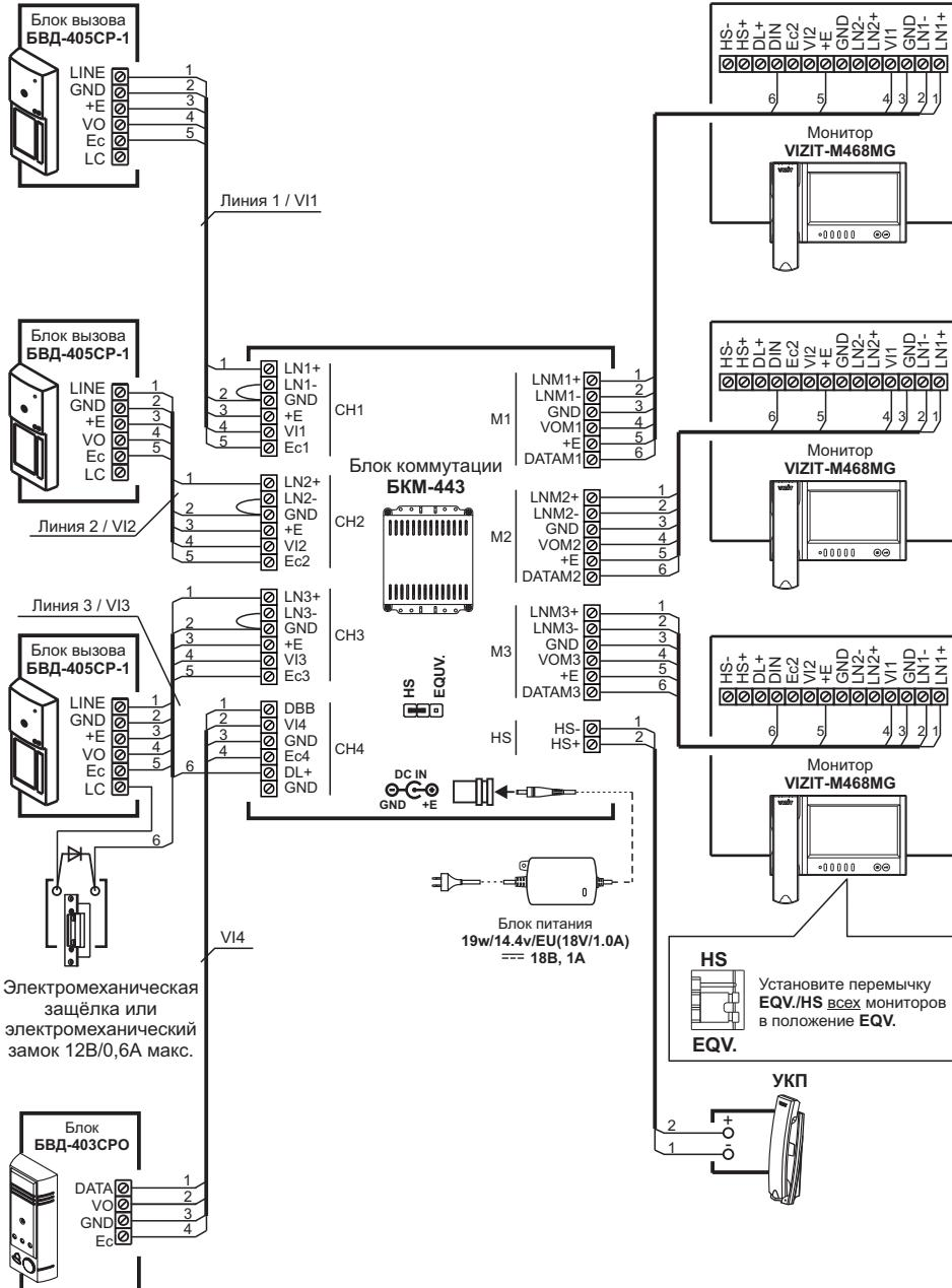
Схема соединений 3-х мониторов и УКП с блоком коммутации БКМ-443, тремя блоками вызова БВД-405СР-1 и блоком БВД-403СРО (телефакамера + кнопка "Звонок")
