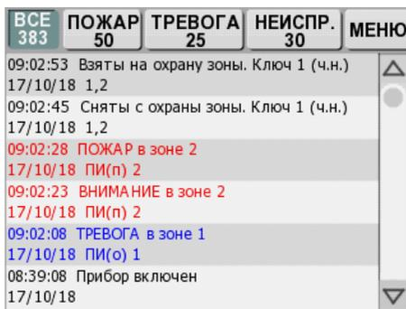
Рис. 2. Основное окно отображения состояние ППКУОП
