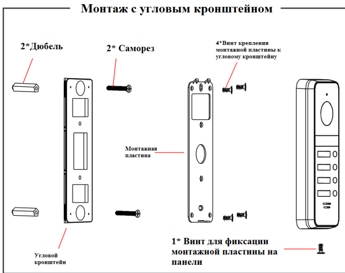
Рисунок 3. Монтаж вызывной панели с угловым кронштейном
