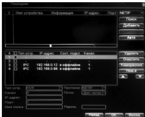
Рис. 9 Список обнаруженных устройств в сети.
