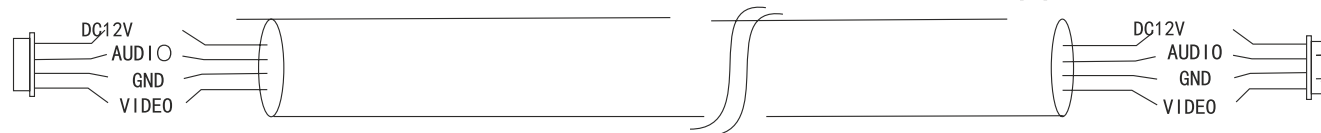
неэкранированный кабель ( \leq 50\text{m} )
