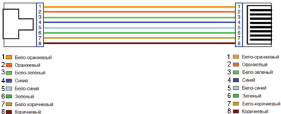
Рис. 10 Разводка кабеля по типу TIA/EIA-568-A.
