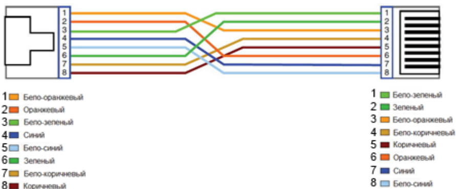
Рис. 12 Разводка кабеля по типу TIA/EIA-568-B.
