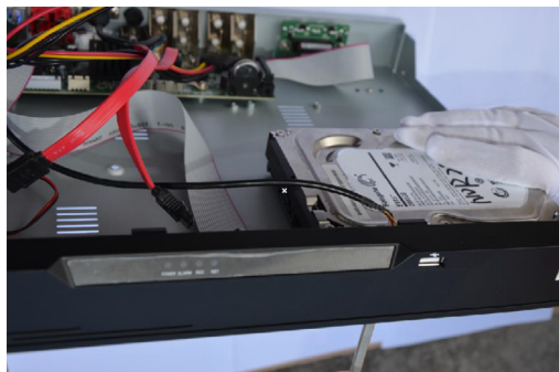
Рис. 11. Установка жесткого диска
