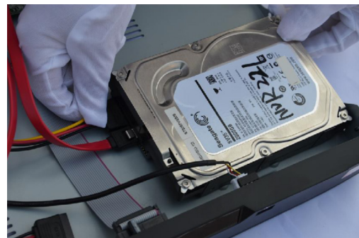
Рис. 12. Установка жесткого диска
