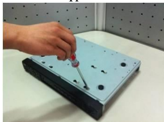
Тесіктер соотvetvuyuschie арқылы бұрандамен астыңғы жағындағы қатты диск бекітіңіз.
