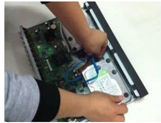
SATA және электр кабельдерін жалғаңыз. шасси төменгі және артқы жағындағы және тұрғын үй жоғарғы қақпағын жабыңыз.
