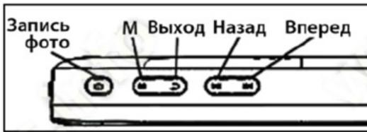
Чтобы включить монитор-регистратор нажмите и удерживайте кнопку «М» до появления приветствия на дисплее. Для отключения звука кратковременно нажмите кнопку «М». Чтобы отключить монитор нажмите и удерживайте в течение 3 секунд кнопку «М», пока пропадет изображение с монитора. Кнопки «Назад» и «Вперед» переключают каналы и пункты меню.
