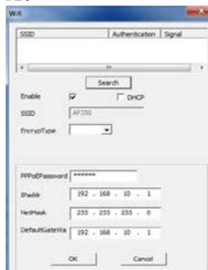
Введите пароль и укажите IP адрес камеры или включите функцию автоматического присвоения ip-адреса (DHCP).
