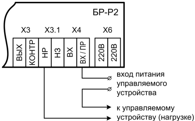
Рис.22 Схема подключения для функциональной проверки работоспособности БР-Р2
