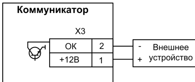
Рис.27 Схема подключения внешнего устройства к коммуникатору
