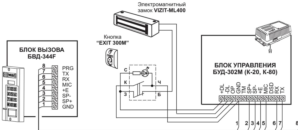
**Примечание.** Подключите провод PRG к клемме GND блока управления при записи МАСТЕР-ключа №1. Отключите провод PRG после окончания записи МАСТЕР-ключа №1.
