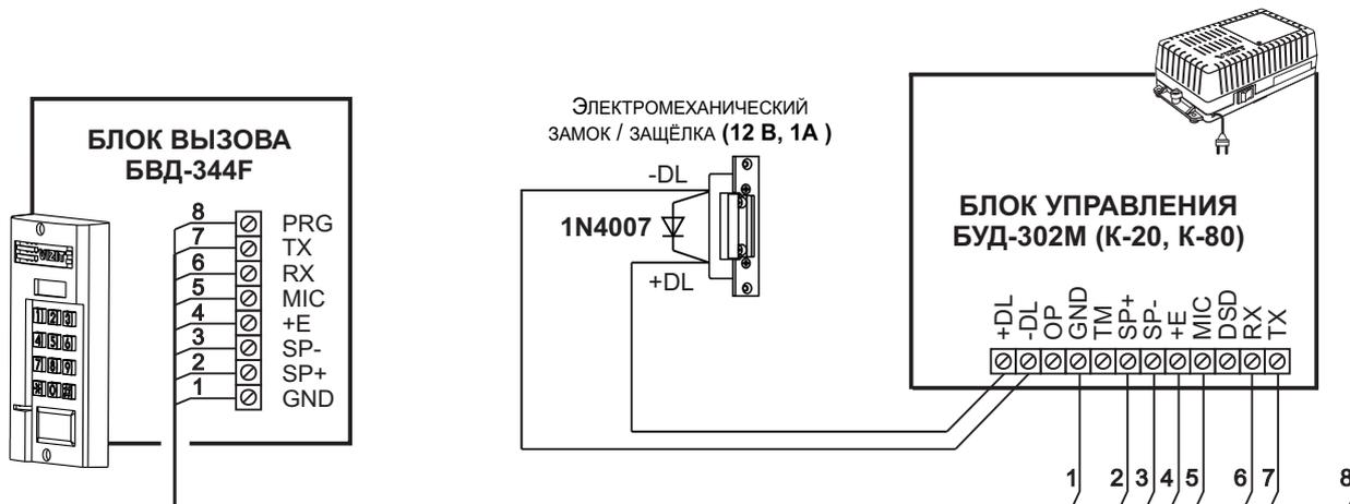
Если электромеханический замок / защёлка не содержат встроенный защитный диод, то между клеммами замка / защёлки следует установить диод, как показано на схеме
