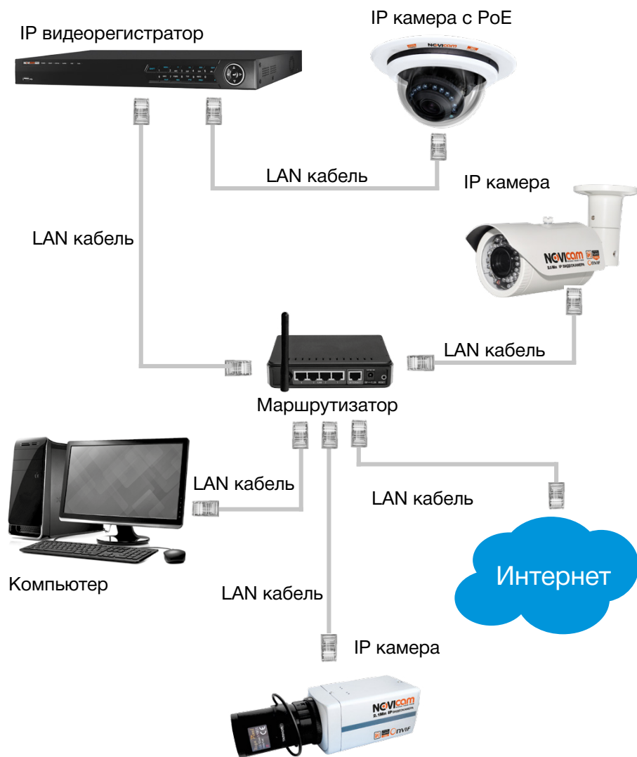
Рисунок 3.19 Подключение IP видеорегистратора с PoE.
