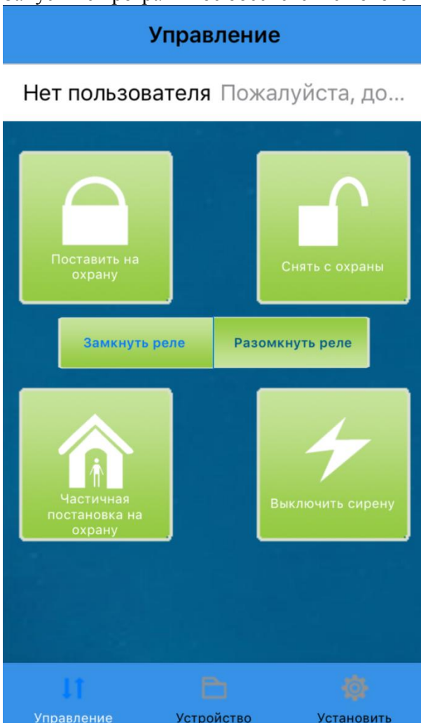
Рис. 1.2. Функции GSMпанели в программном обеспечении мобильного телефона
