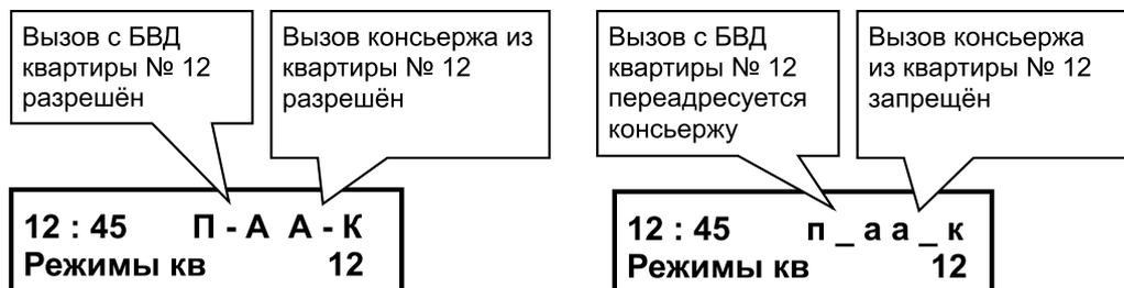
2. Для включения / выключения переадресации вызова набранного номера на консьержа нажмите **MODE/Режим**.
