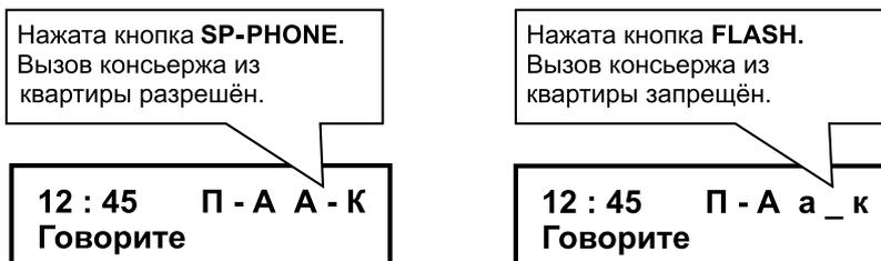
Для сохранения изменений нажать кнопку **STORE/Сохранить**. Блок управления переходит в дежурный режим. Разрешить связь "Абонент - Консьерж" для данной квартиры можно только в режиме **сервисных установок**.
