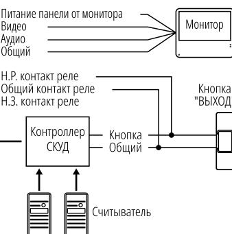
**Схема подключения вызывной панели LEGEND к контроллеру СКУД****РУКОВОДСТВО ПОЛЬЗОВАТЕЛЯ**
