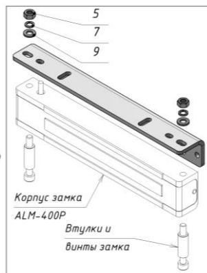
Рисунок 1 – Установка корпуса и якоря замка с комплектом МК 300-400-IN
