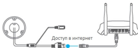
Рисунок 5-3 Подключение к роутеру
