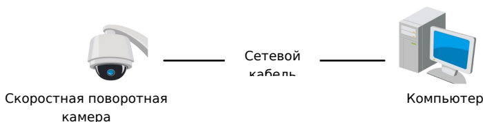
Рисунок 3-1 Подключение камеры напрямую
