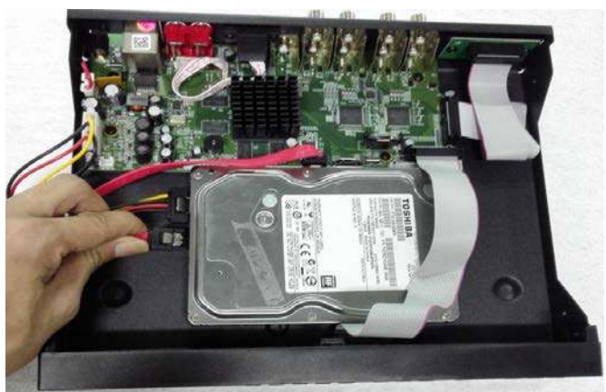
Шаг 5: Подсоедините кабель передачи данных к материнской плате видеорегистратора
