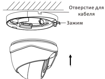
Рисунок 2-6 Установка камеры
