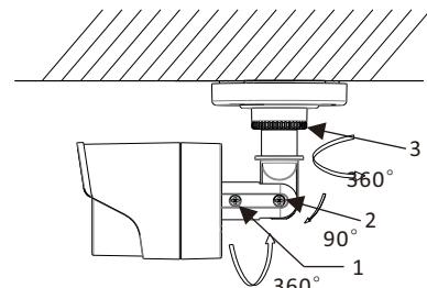
Рисунок 2-3 3-х осевая установка
