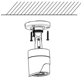
Рисунок 2-2 Установка камеры на потолок
