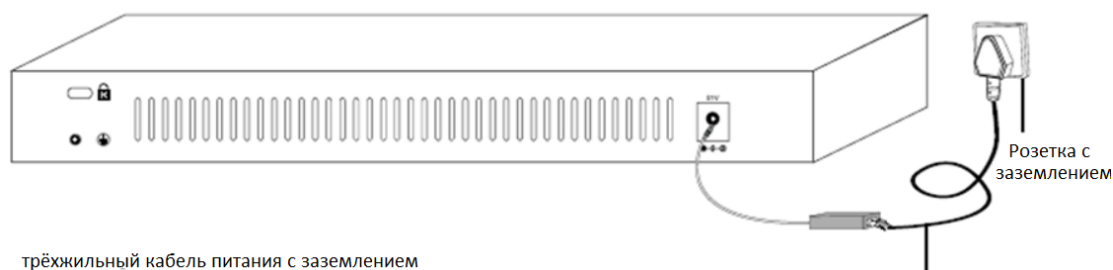
Рисунок 2.9 Заземление с использованием трехжильного кабеля питания
