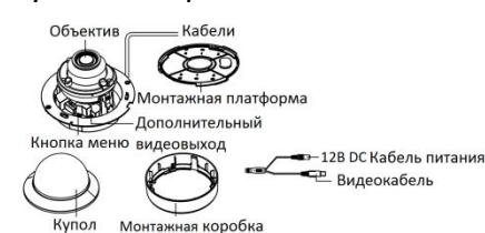
Рисунок 1-14 Купольная камера III типа
