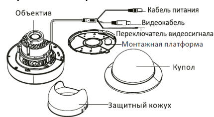
Рисунок 1-13 Купольная камера II типа
