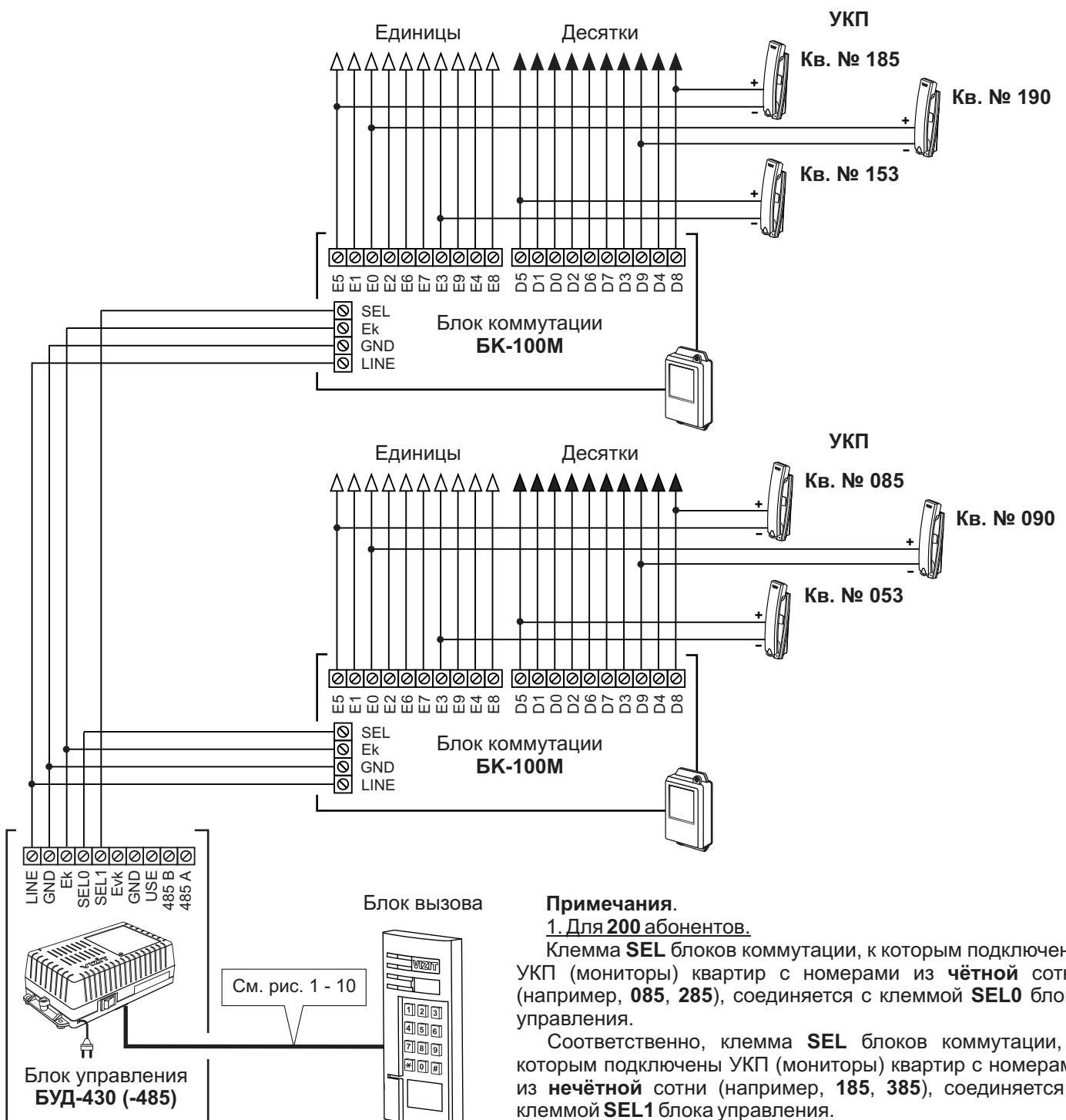
Рисунок 14 - Схема соединений блока управления **БУД-430 (-485)** с блоком коммутации **БК-100М** и УКП в составе многоквартирного домофона до 200 абонентов
