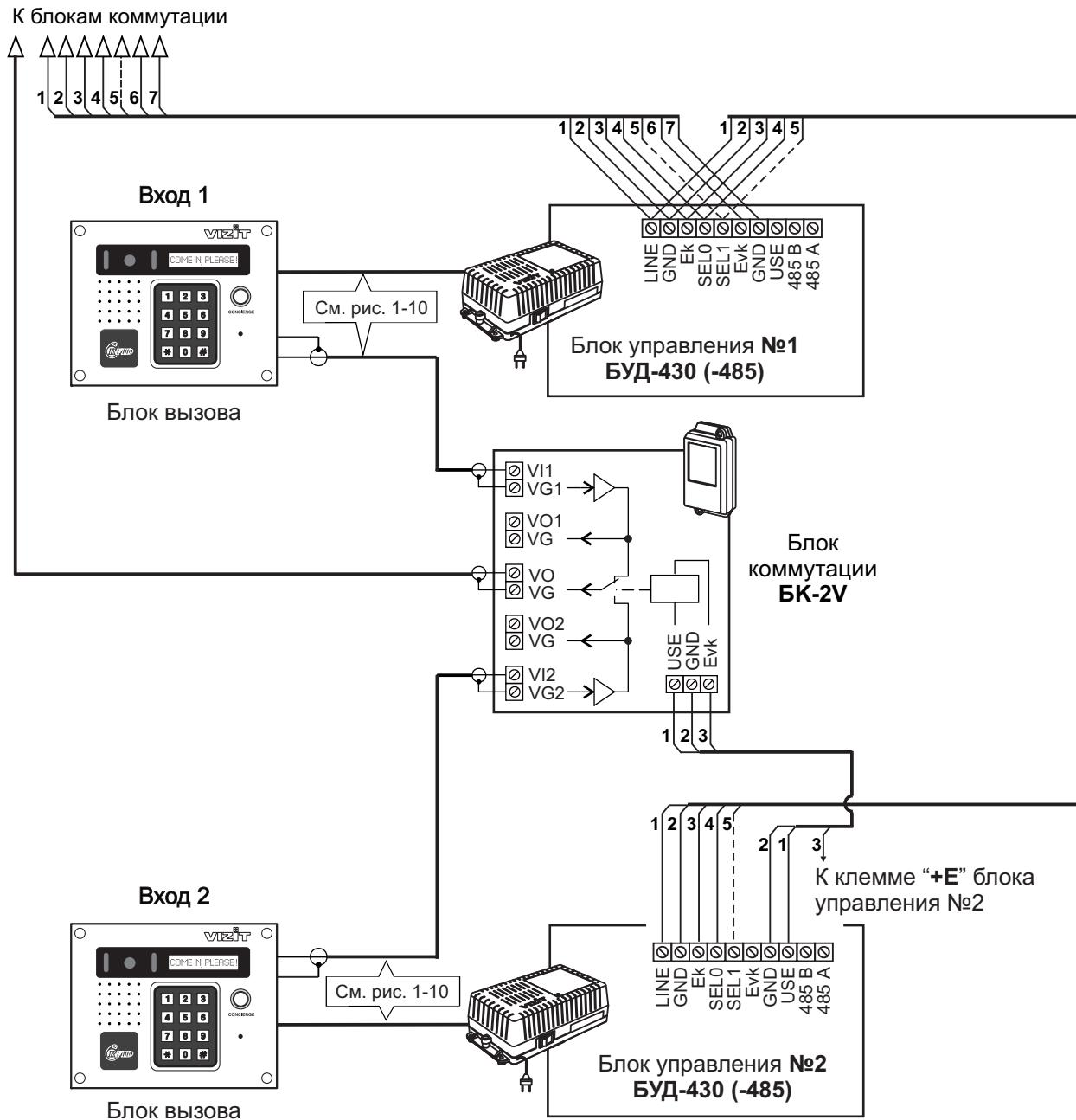
Рисунок 21 - Схема соединений двух блоков управления БУД-430 (-485)
