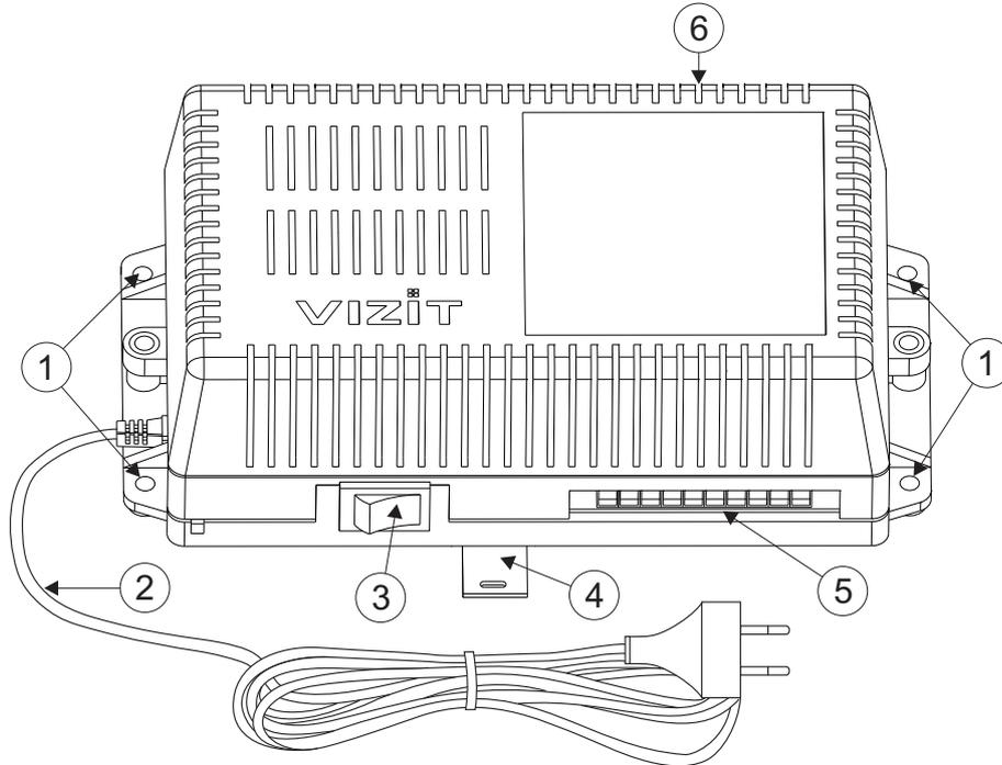
1. Отверстия для крепления блока управления на стену
