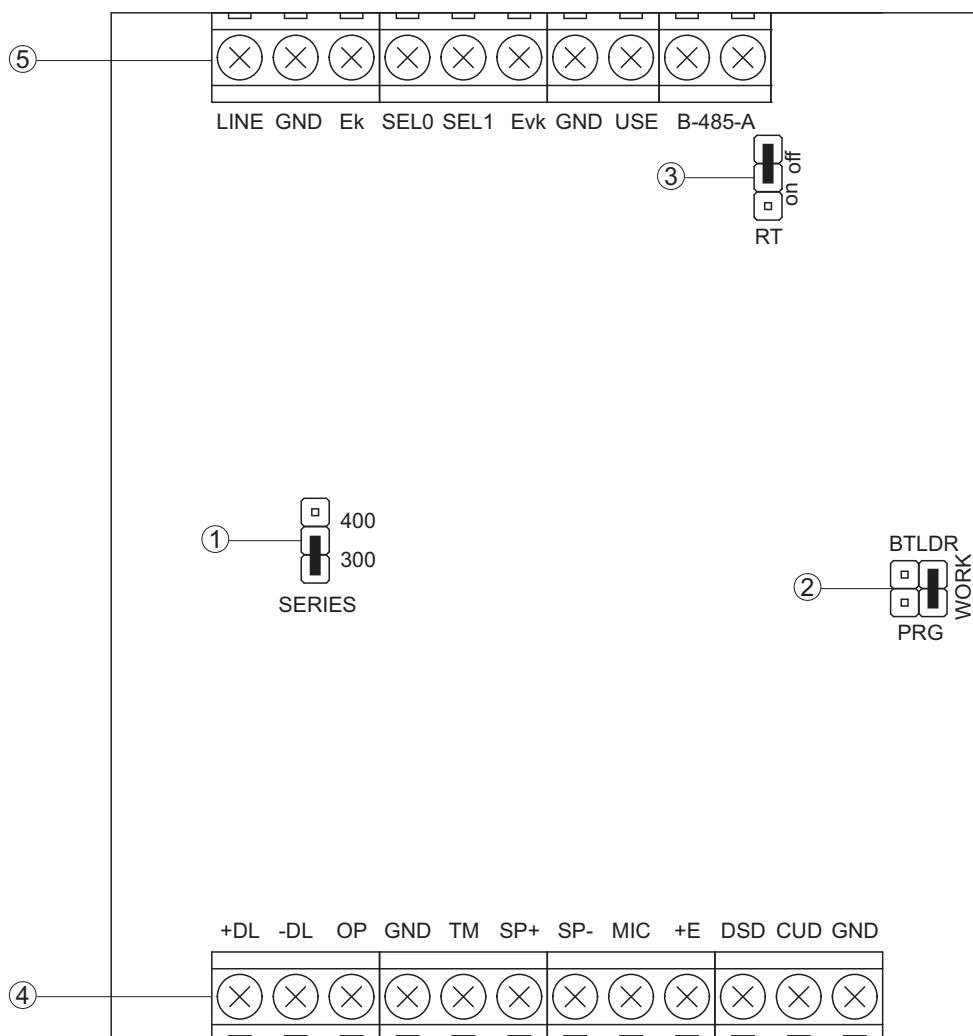
(1) - Перемычка **SERIES**. Устанавливается в положение:
