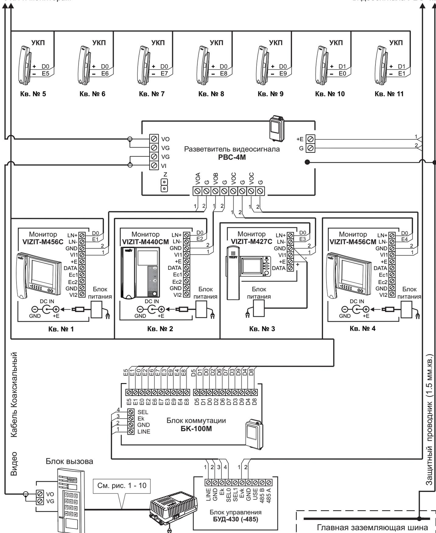
Рисунок 19 - Схема соединений блока управления **БУД-430 (-485)** с блоком коммутации **БК-100М**, разветвителем видеосигнала **PBC-4M** и мониторами **VIZIT** в составе многоквартирного видеодомофона до 100 абонентов
