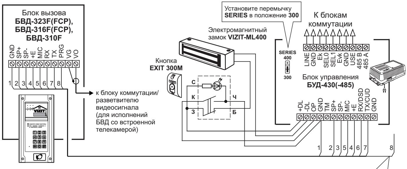
Рисунок 1 - Схема соединений блока вызова **БВД-323F(FCP), БВД-316F(FCP), БВД-310F** с блоком управления **БУД-430(-485)**, электромагнитным замком **VIZIT-ML400** и кнопкой **EXIT 300M**
