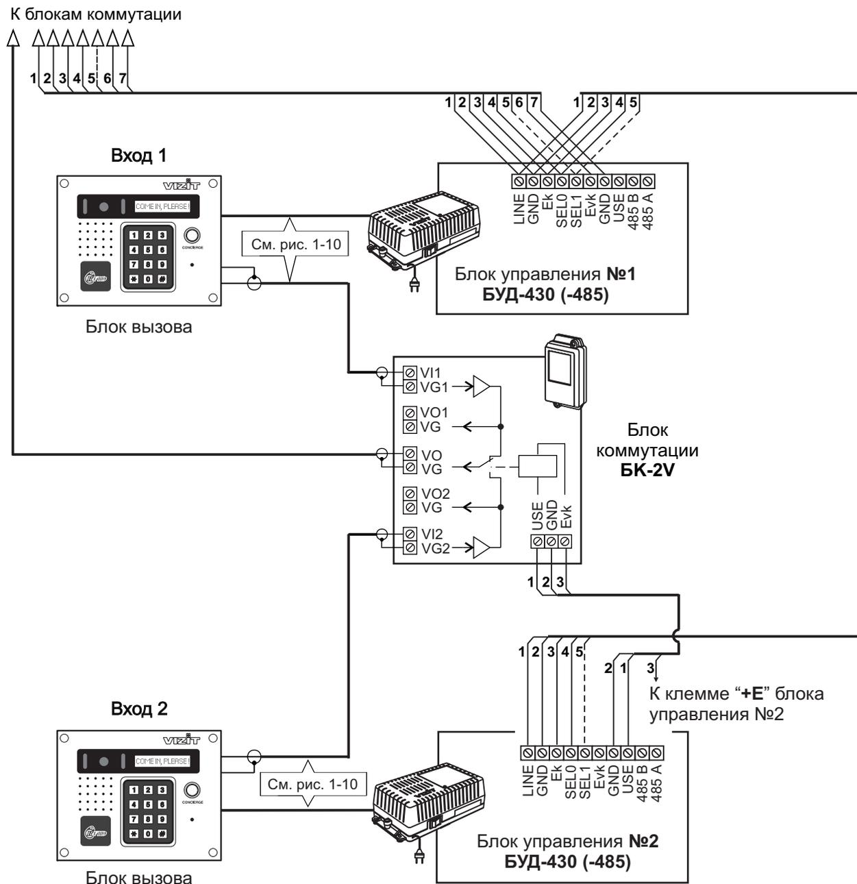
Рисунок 21 - Схема соединений двух блоков управления БУД-430 (-485) в составе многоквартирного видеодомофона
