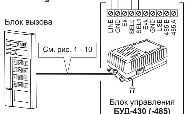
Рисунок 13 - Схема соединений блока управления **БУД-430 (-485)** с блоком коммутации **БК-30М** и УКП в составе многоквартирного домофона до 200 абонентов
