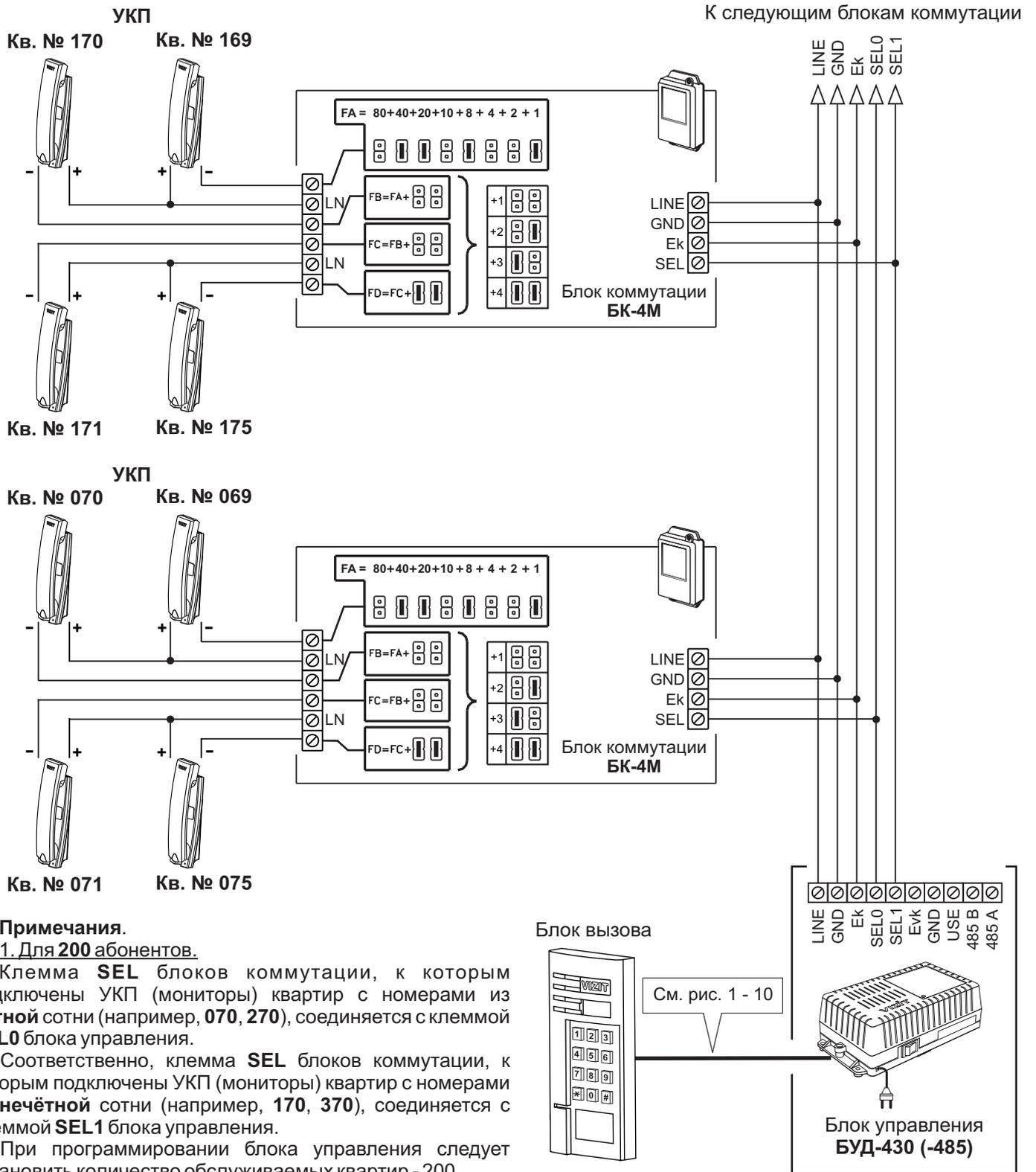
Рисунок 11 - Схема соединений блока управления **БУД-430 (-485)** с блоком коммутации **БК-4М** и УКП в составе многоквартирного домофона до 200 абонентов
