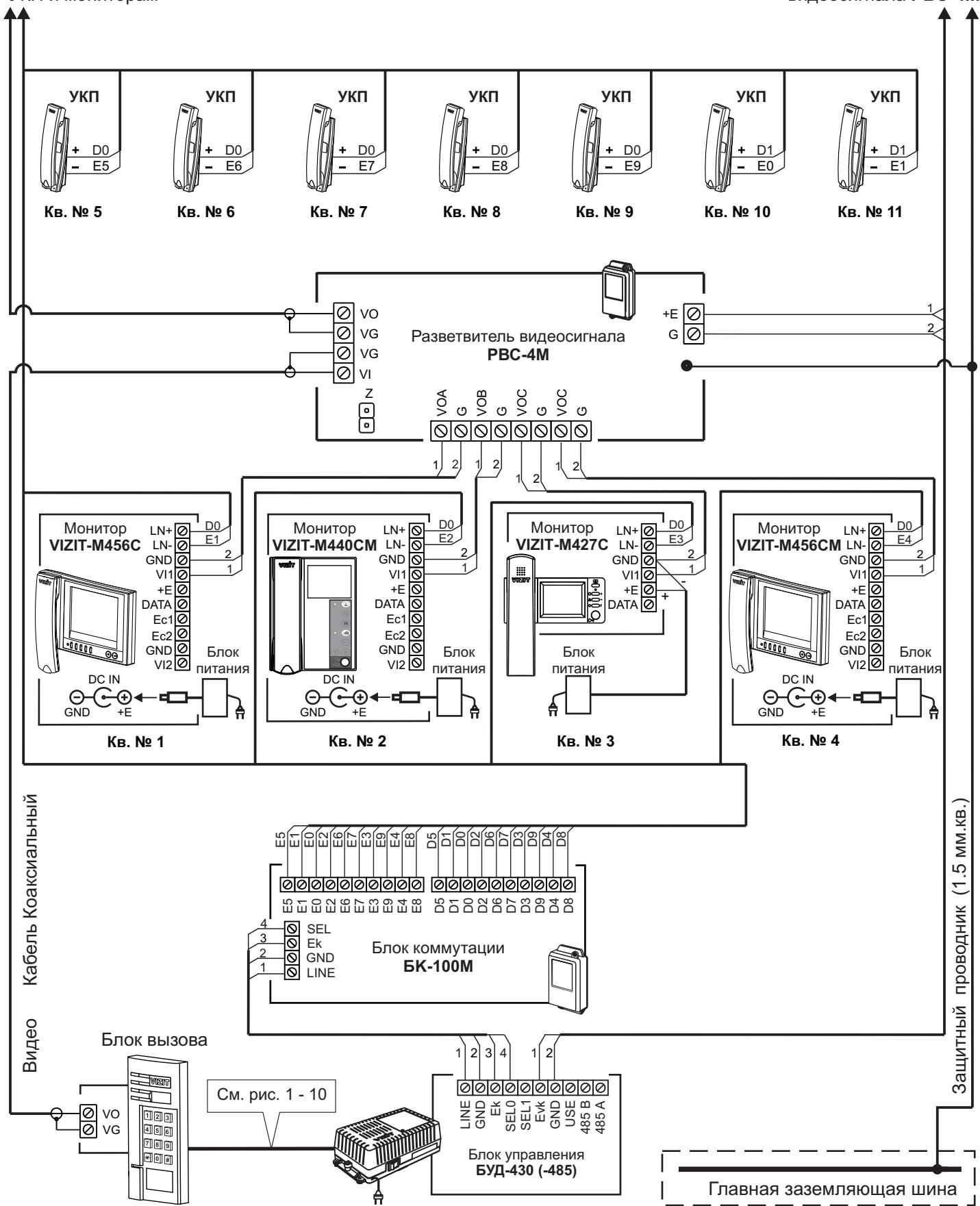
Рисунок 19 - Схема соединений блока управления БУД-430 (-485) с блоком коммутации БК-100М, разветвителем видеосигнала РВС-4М и мониторами VIZIT в составе многоквартирного видеодомофона до 100 абонентов
