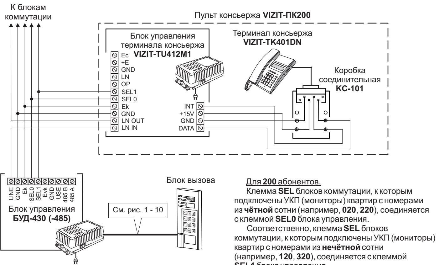
Рисунок 16 - Схема соединений блока управления **БУД-430 (-485)** с пультом консьержа **VIZIT-ПК200** в составе многоквартирного домофона до 200 абонентов
