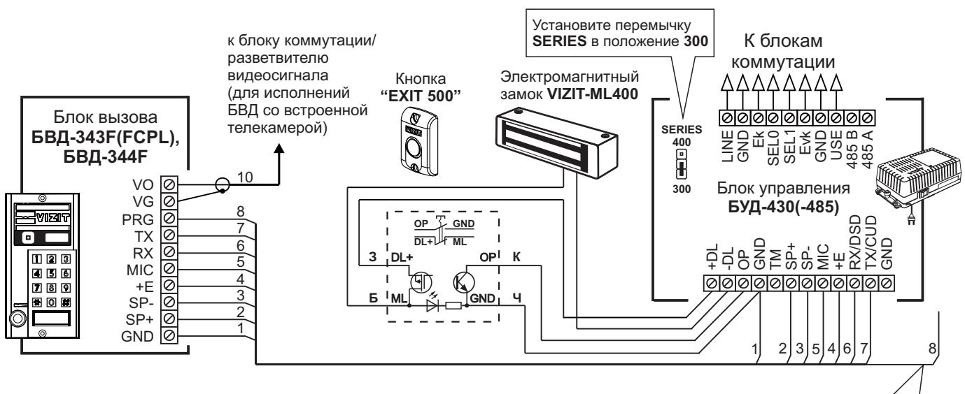
Рисунок 2 - Схема соединений блока вызова **БВД-343F(FCPL), БВД-344F** с блоком управления **БУД-430(-485)**, электромагнитным замком **VIZIT-ML400** и кнопкой **“EXIT 500”**
