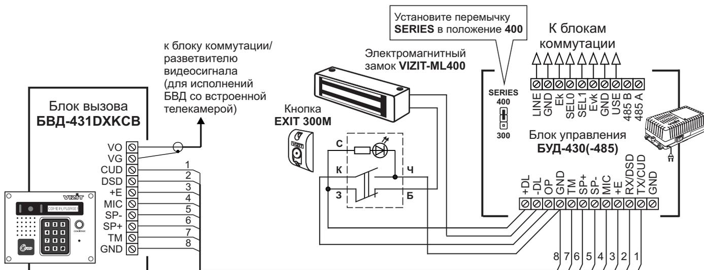
Рисунок 8 - Схема соединений блока вызова **БВД-431DXКСВ** с блоком управления **БУД-430(-485)**, электромагнитным замком **VIZIT-ML400** и кнопкой “**EXIT 300M**”
