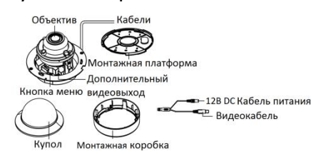
Рисунок 1-14 Купольная камера III типа
