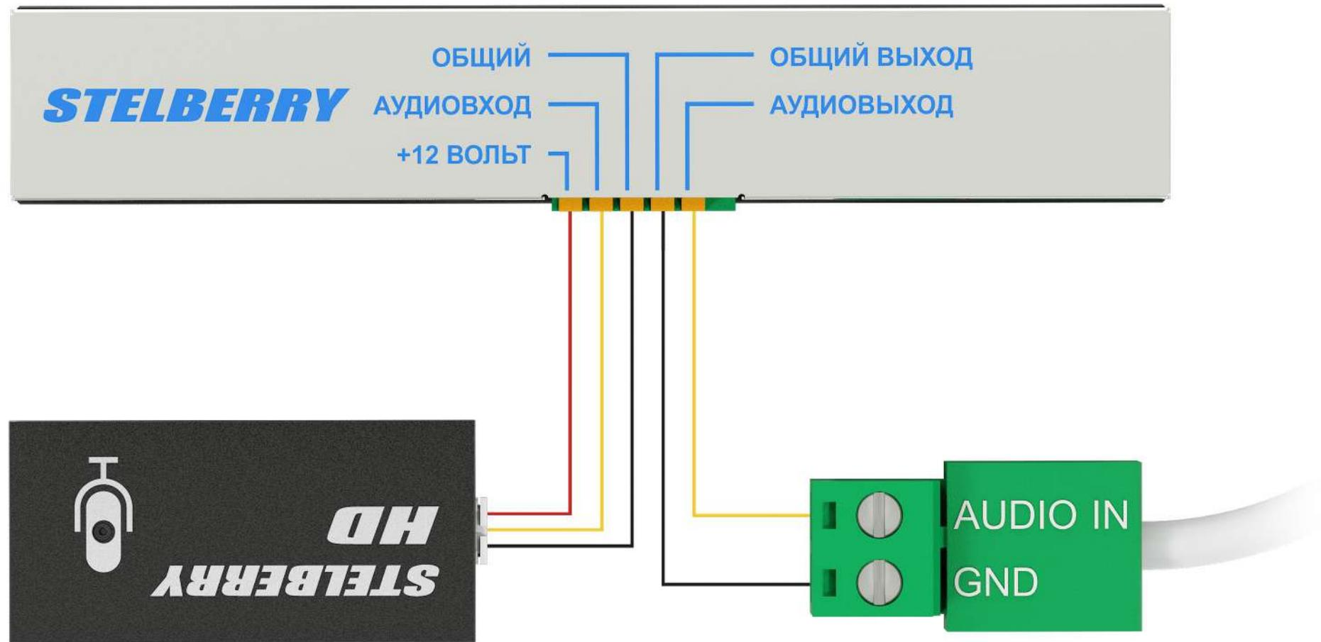
На первые три клеммы подключается микрофон, а оставшиеся две клеммы являются линейным аудиовыходом, который необходимо подключить к аудиовходу камеры. Микрофон подключайте экранированным кабелем, например ШСМ 4x0,08. Главное, чтобы жёлтый провод микрофона (аудиовыход) подключался к экранированной жиле, а чёрный (общий) к экрану. Если сплиттер расположен рядом с камерой, то подключение к аудиовходу камеры можно производить неэкранированным кабелем.
