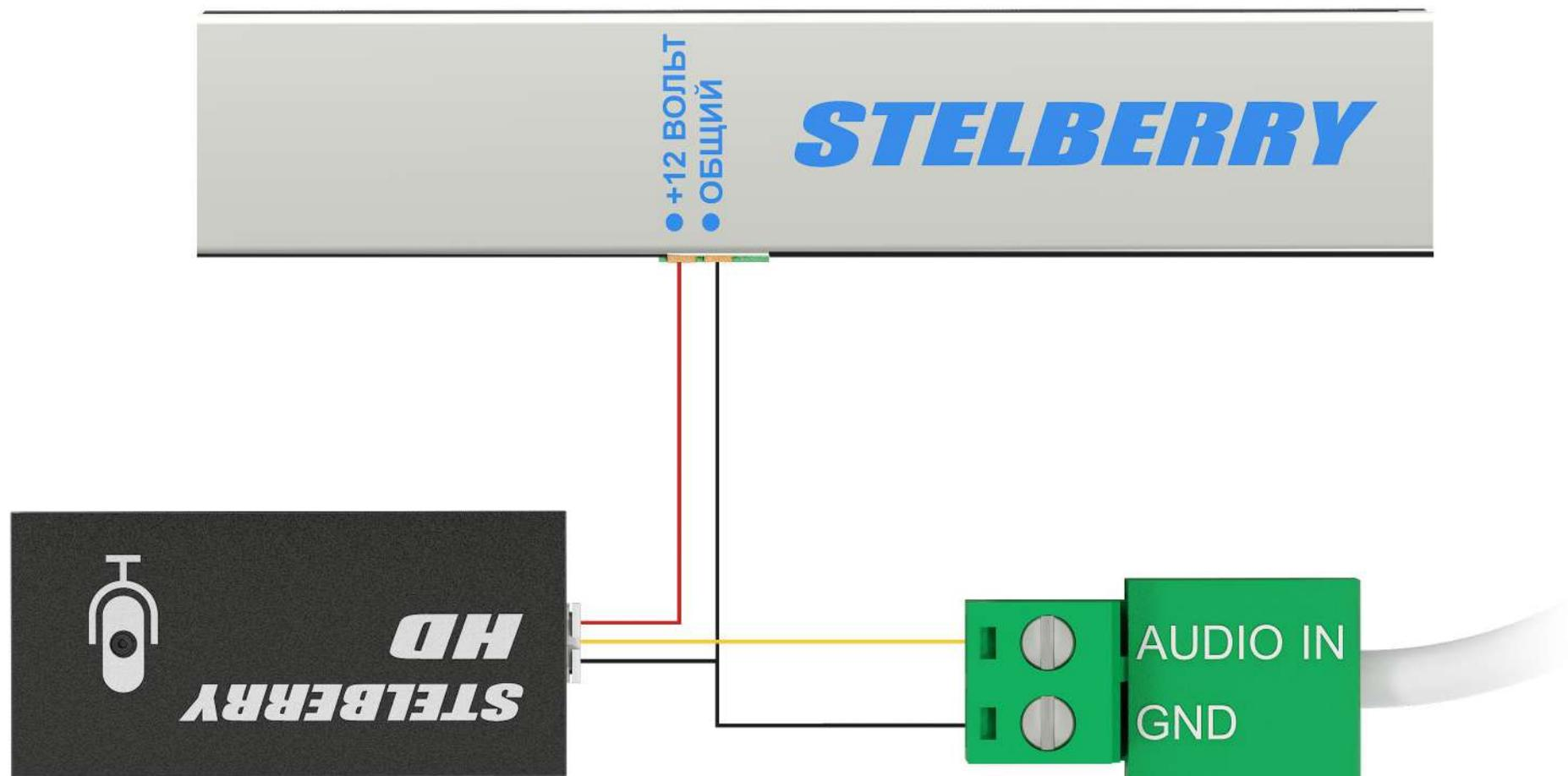
Соедините между собой сплиттер, микрофон и аудиовход IP камеры, согласно схеме.
