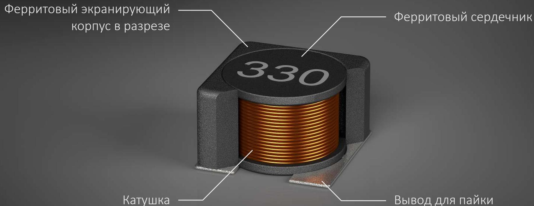
Ферритовый экранирующий корпус не допускает выхода электромагнитных излучений за пределы катушки и наделяет индуктивность более высокой добротностью при миниатюрных размерах.
