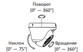
Рисунок 1-15 Настройка угла наблюдения камеры
