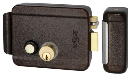
Замок ST-RL073DI-BR предназначен для запирания дверей, калиток, ворот и может применяться совместно с системами контроля доступа (контроллеры, домофоны, кодовые панели). Управление замком осуществляется электрическим или механическим способом. Для удаленной разблокировки ST-RL073DI-BR необходима кратковременная подача напряжения. Замок можно открыть ключом снаружи или кнопкой изнутри, кроме того, его можно заблокировать ключом с внутренней стороны.
