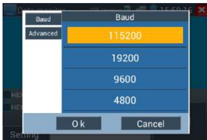
Рис.3.3.14-1 Настройка мониторинга данных по протоколу RS485
