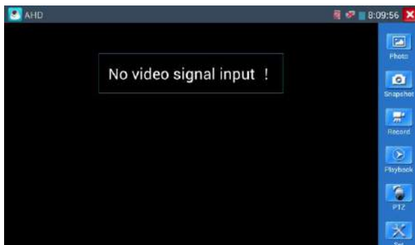
Рис.3.3.8.-1 Главное окно режима AHD в отсутствии сигнала
