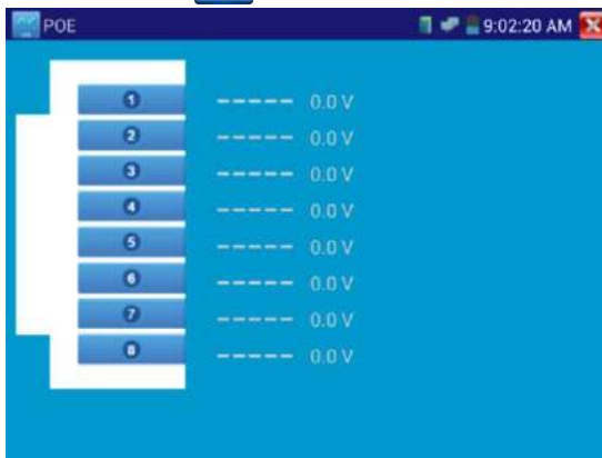
Рис. 3.3.21-1 Напряжение PoE на линиях кабеля витой пары
