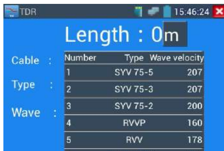
Рис. 3.3.22-2 Выбор параметров кабеля
