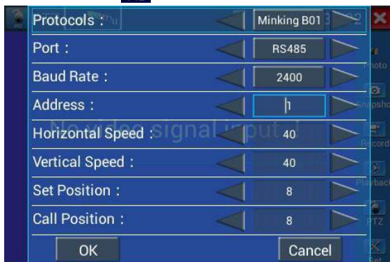
Рис.3.3.1-2 Окно настройки протокола
