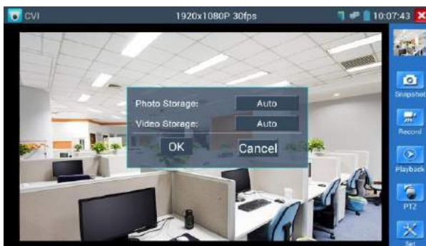
Рис.3.3.6.-6 Настройка параметров сохранения
