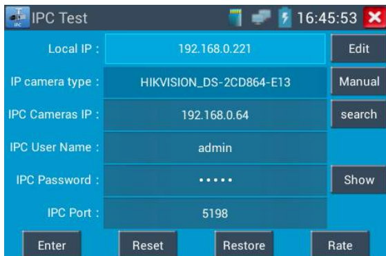
Рис.3.3.4-1 Интерфейс режима IPC-тест
