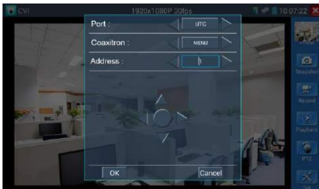
Рис.3.3.6.-5 Установка параметров протокола Coaxitron
