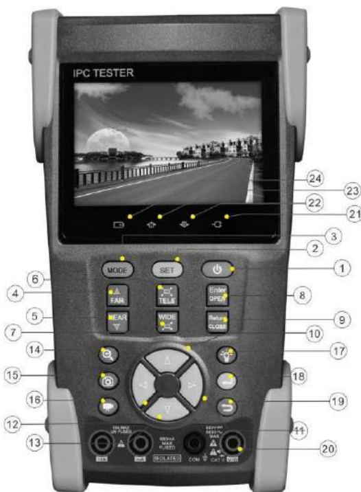
Рис. 2.2-1 Элементы экранного интерфейса и органы управления тестера TIP-3.5
