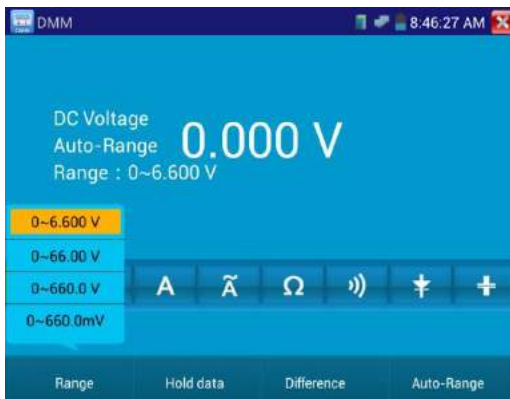
Рис.3.3.17-2 Выбор режима измерений.
