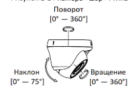
Рисунок 1-15 Настройка угла наблюдения камеры
