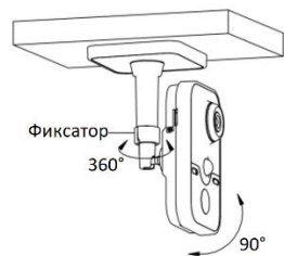
Рисунок 1-25 Настройка угла наблюдения камеры
