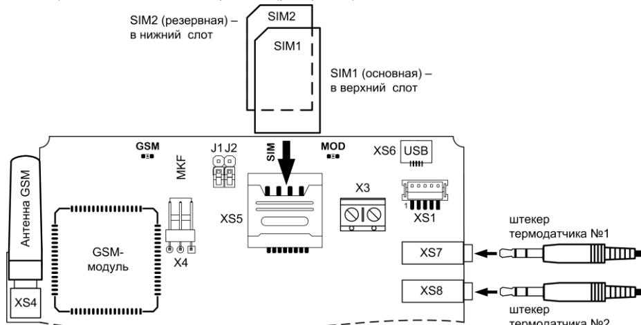
Рис.3б Коммуникатор. Установка SIM-карт. Подключение термодатчиков
