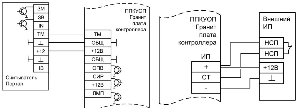
**Рис.Б5** Схема подключения считывателя «Портал»
