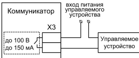
**Рис.4** Схема подключения внешнего управляемого устройства к коммуникатору
