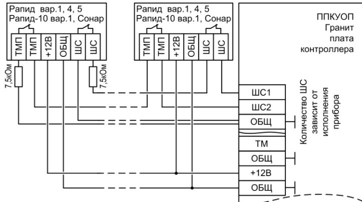
**Рис.Б3** Схема подключения охранных извещателей Рапид вар.1,4,5, Рапид-10 вар.1, Сонар (тампер подключен к отдельному ШС)
