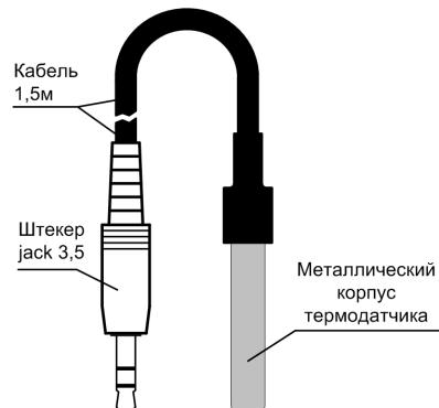
Рис.6 Термодатчик «DS18B20 L=1,5m, jack 3,5 mm».
