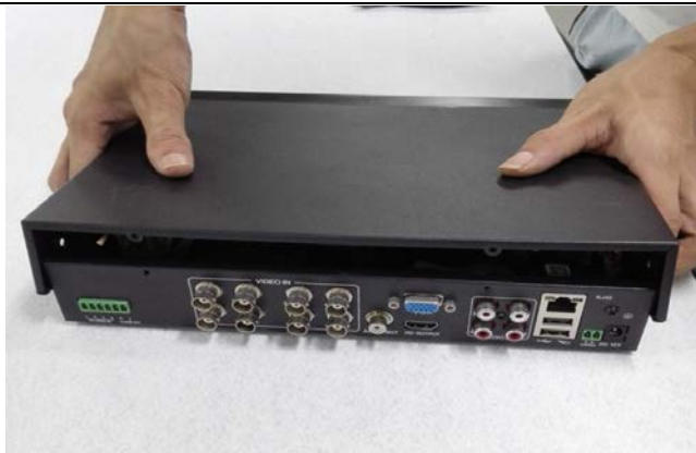
Шаг 3: Снимите верхнюю крышку
