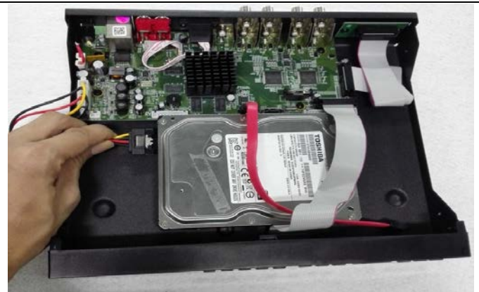
Шаг 4: Установите жёсткий диск, подсоедините кабель питания к материнской плате видеорегистратора
