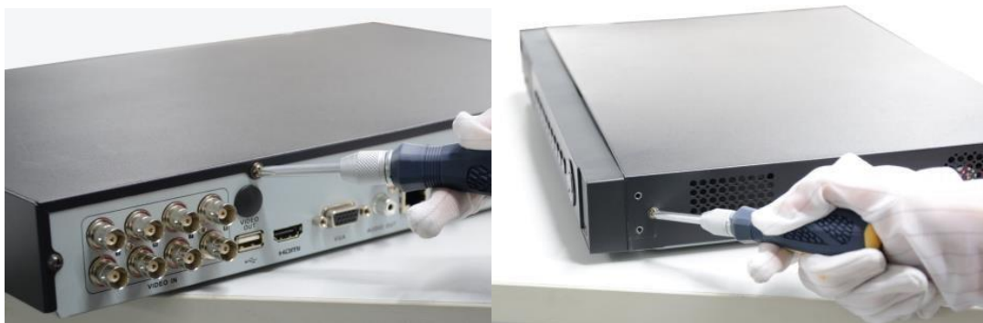
Рисунок 2.1 Снимите крышку DVR
