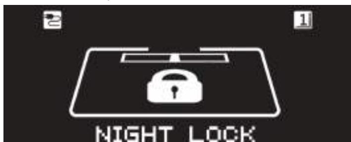
Двери закрыты, датчики-радары отключены. При наличии замка двери дополнительно блокируются в закрытом состоянии
