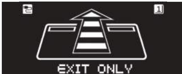
Двери работают в автоматическом режиме (работает только датчик на выход)
