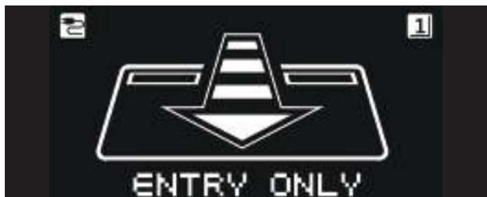
Двери работают в автоматическом режиме (работает только датчик на вход)
