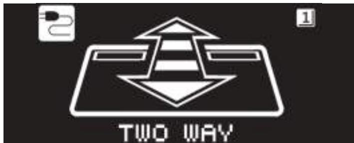
Двери работают в автоматическом режиме на вход и на выход (активация от любых управляемых устройств)
