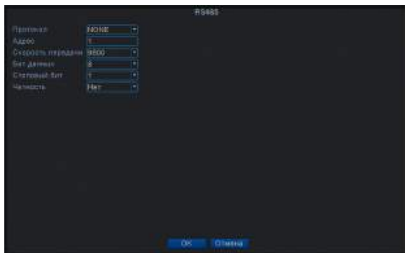
Рисунок 4.33 Конфигурация RS485 устройств в цифровом режиме.
