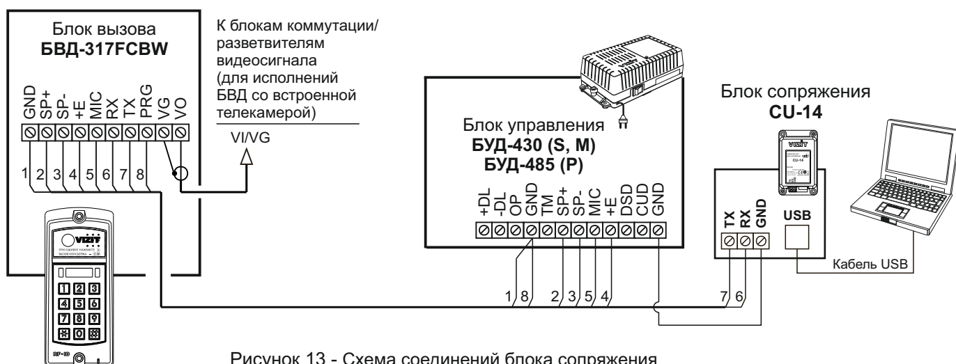
Рисунок 13 - Схема соединений блока сопряжения с блоками управления БУД-430 (S, М) , БУД-485 (Р)
