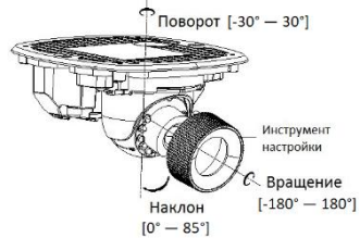
Рисунок 1-23 Настройка угла наблюдения камеры
