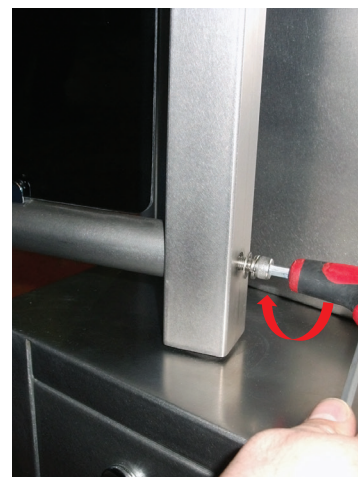
3. Затяните нижний винт
